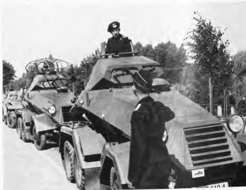
Abb. 34. Deutsche schwere und leichte Panzerspähwagen (der zweite Panzer trägt eine Antenne)
