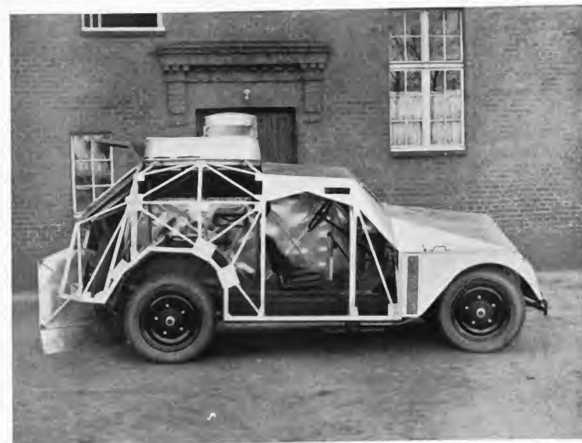
Abb. 32. Deutsche Panzerspähwagen-Attrappe (geöffnet) unter dem Versailler Vertrag, 1931
