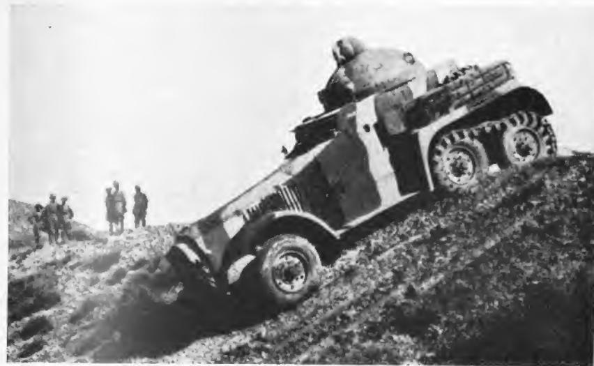
Abb. 27. Englischer Panzerpähwagen Vickers-Guy mit aufgelegten Ketten um die Hinterräder
