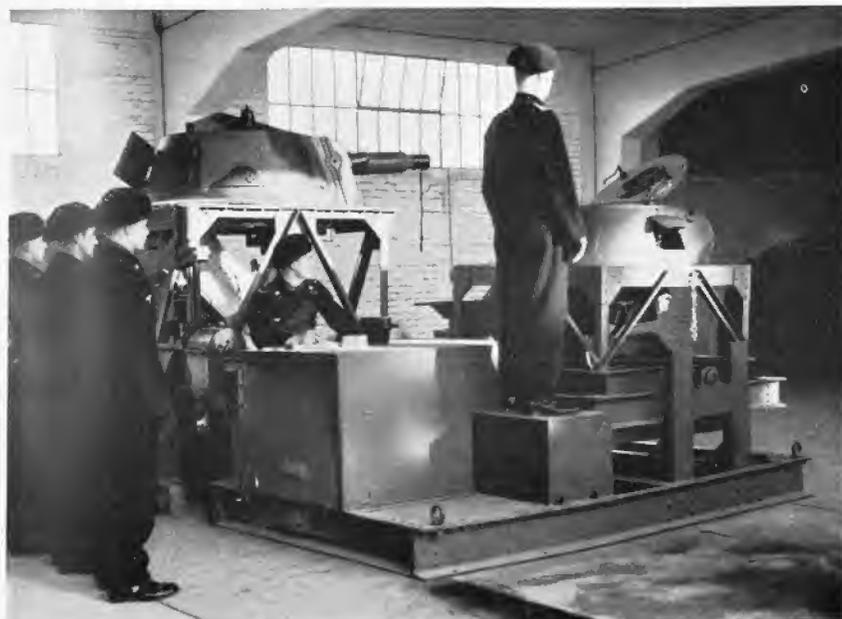
Abb. 49. Kleinkaliberschießen vom Rüttelstand
